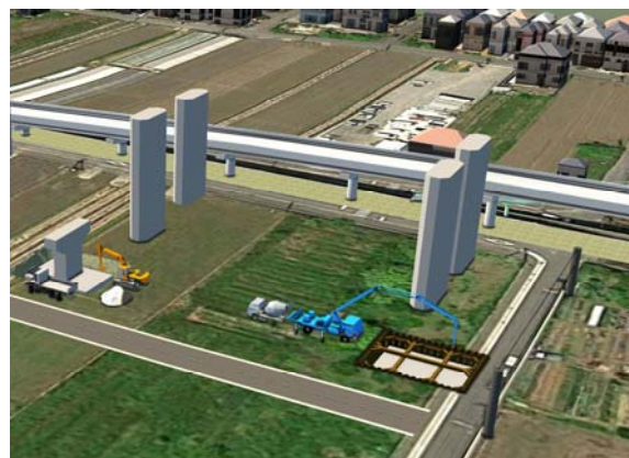
(b) 下部工躯体施工時
