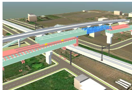
(a) 送り出し架設
