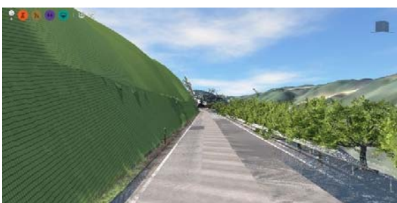
図-8 ブロック積に緑色ネットを覆い、かつ、右側の高木区間を低木に変更したモデル
