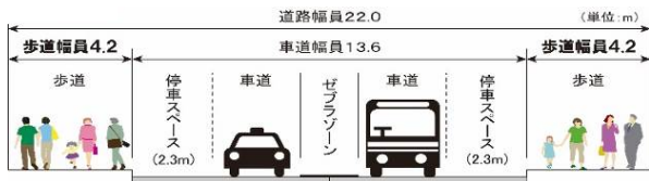
図-6 沿道アクセススペース部の横断構成
