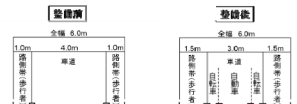
図-7 車道外側線の引き直しとカラーラインの設置状況
