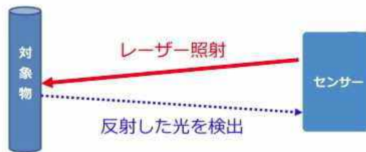
図 9.2.2 測位のイメージ図（空間情報クラブ HP より抜粋）
