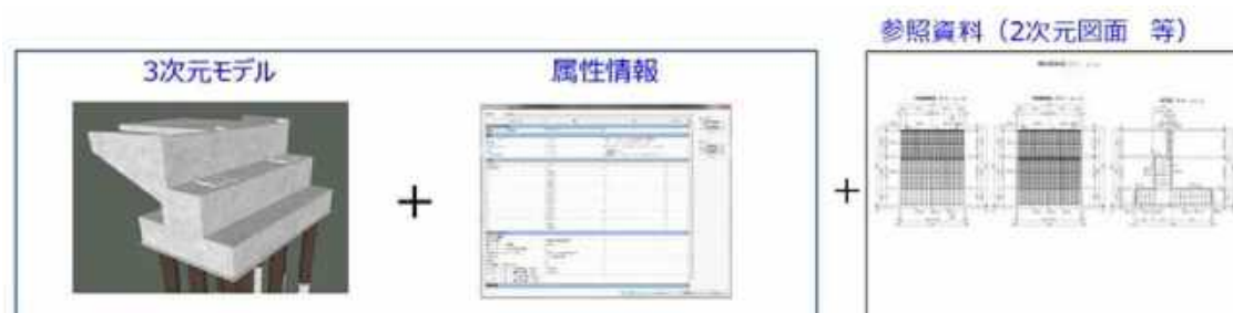
図 2.1.4 BIM/CIM モデルの構成
