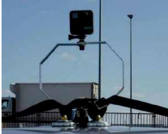
写真一 2 カメラ架台
