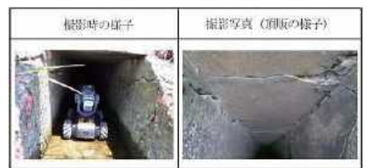
地上歩行ロボットでの撮影の様子
