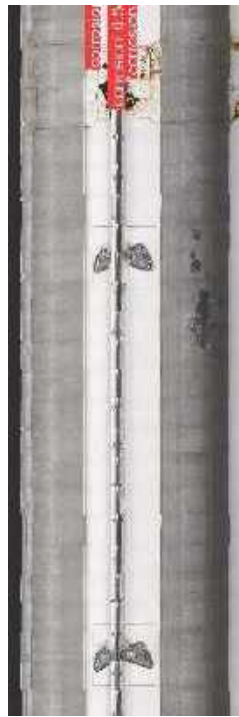
YOLOによる腐食検出結果
