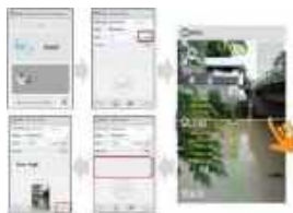
図●AR技術を活用して水位を計測するスマートフォンアプリ
