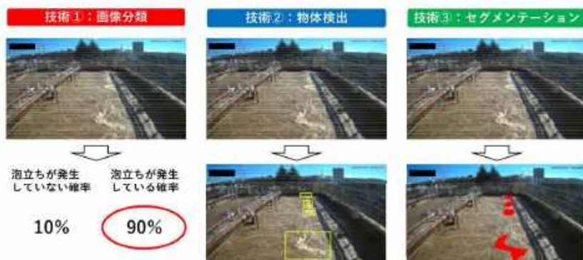
図 AI画像解析技術の分類 (例: 排水処理施設での泡立ち検知の場合)
