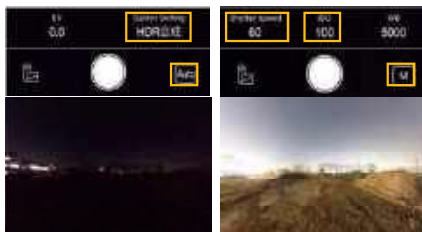
写真-5 撮影モードによる比較 (照明車なし)
