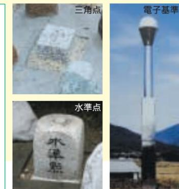
GPS衛星からの電波を連続的に受信する新しい基準点として設置されたものです。全国に約20km間隔で約1200点設置されています。
