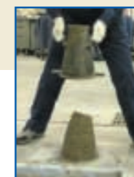
コーンを引き抜いた後、最初の高さからどのくらい下がる(スランプする)かを測る。(スランプ値が大きい=軟らかい)
