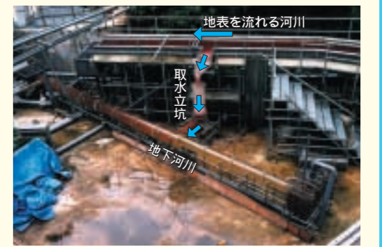
1/20模型での実験風景
