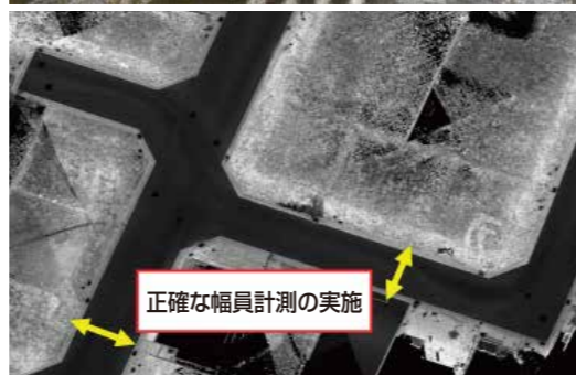
路面オルソによる幅員計測
