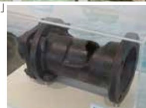
土木遺産の対象となった被災水道管
