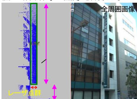
図-7 突出看板の計測例
