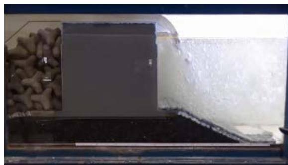
図 7 実験状況図(対策-8t ブロック)
