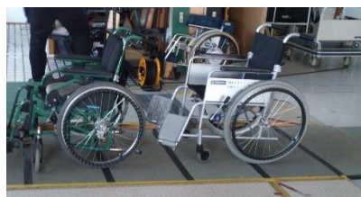
図-1 実験に使用する車いす(左から、後輪前より座席位置低(以下、車いすA)、一般的な車いす(以下、車いすB))
