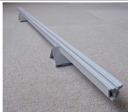
写真-3 簡易取付け治具(チップボール製)
