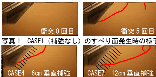
写真2 崩壊開始時の盛土
