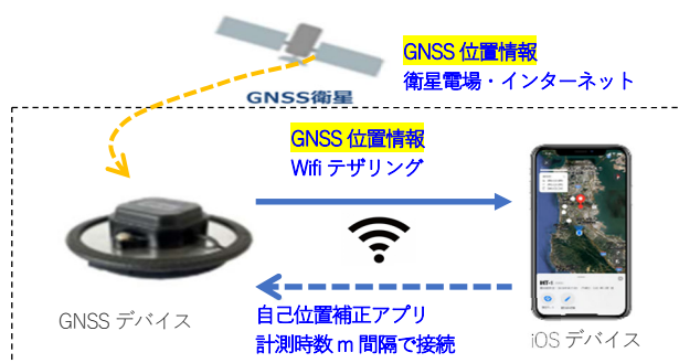
図-9 RWP を用いた自己位置補正の概要図
