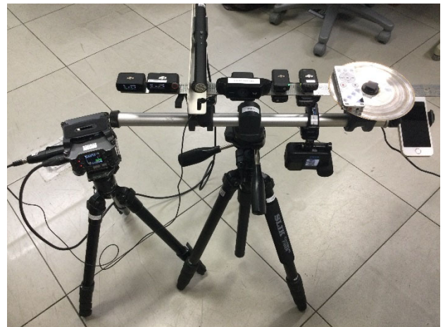
図-1 ハンマー打音収集装置の概観
