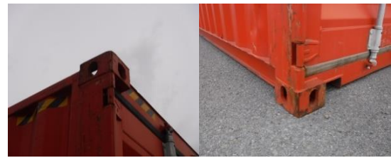
図-4 コンテナのキャスティングブロックとその穴
