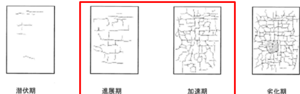
解説 図 2.2.1 床版下面のひび割れ進行
