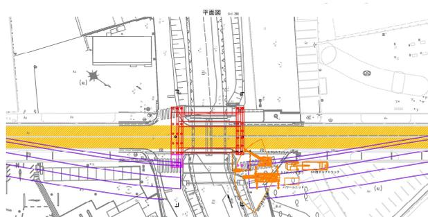
図-13 施工ステップ平面図 (下部工構築 A2 橋台時)
