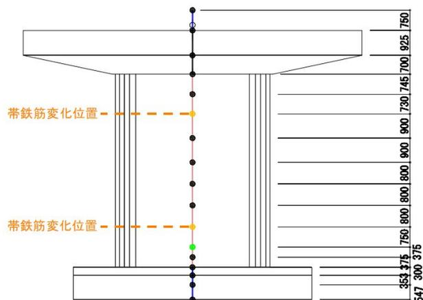
図-3 橋脚モデル節点分割図
