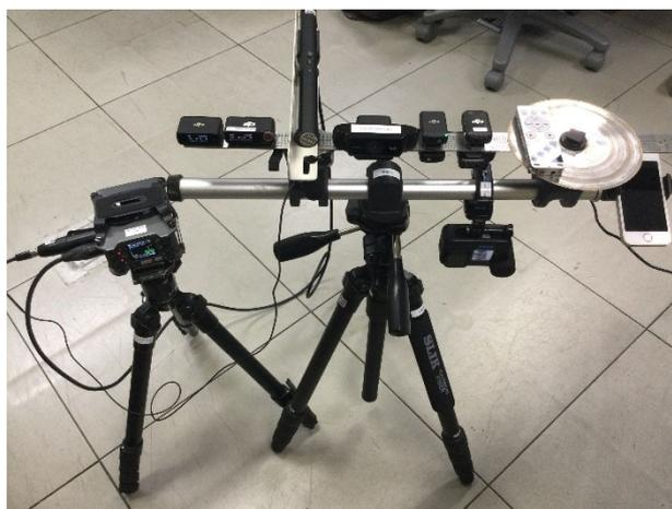
図-1 ハンマー打音収集装置の概観
