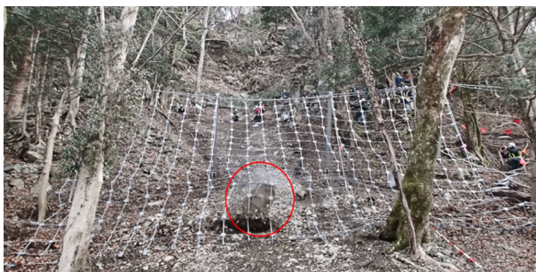
写真-3 落石減勢工衝突時の状況 (落石 No. A 捕捉時)
