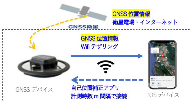
図-9 RWP を用いた自己位置補正の概要図
