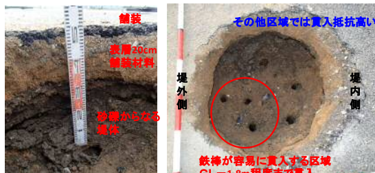
図-2 簡易試掘状況
