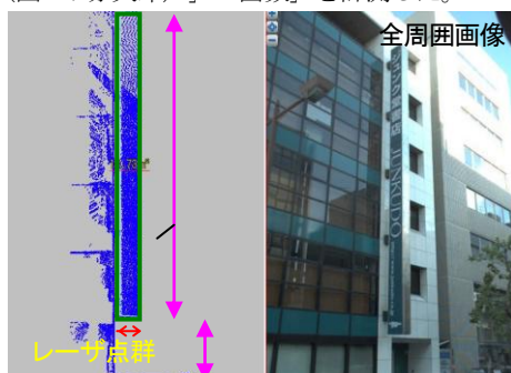
図-7 突出看板の計測例
