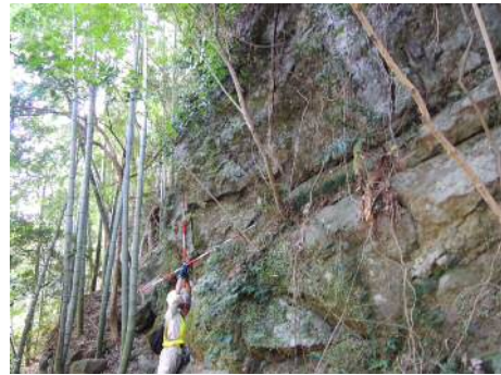
写真-1 露岩の一部 (亀裂が全体的に発達し所々で浮石化)
