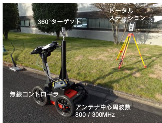
図-7 根系分布診断の使用機器
