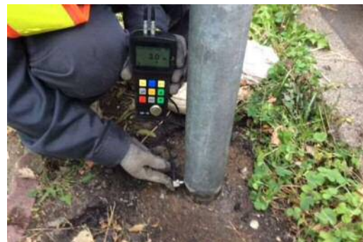
写真-3 路面境界部の板厚調査状況
