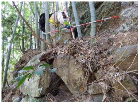
写真-3 露岩下部の転石群 (露岩から抜け落ちたと推定)
