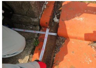
(a) 直角方向水平変位 (40mm)
