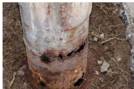
写真ー2 路面境界部の腐食事例(引用文献 1) )
