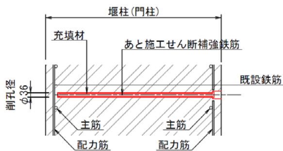
図-5 せん断対策概要断面
