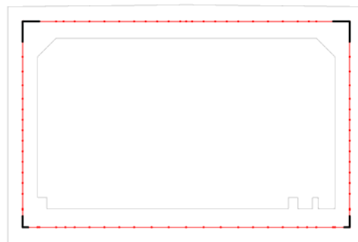
図-2 構造部材モデル図(梁要素)
