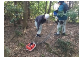
図-7 磁気探査状況
