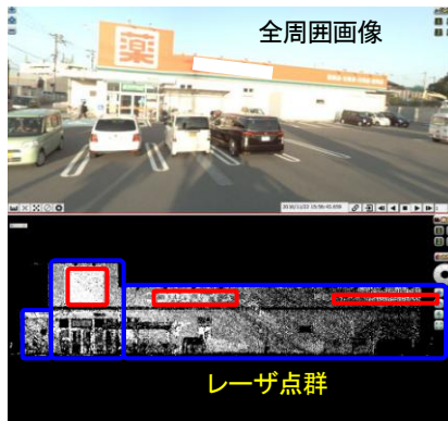
図-5 壁面看板の計測例
